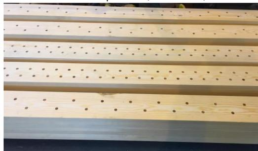
Abb. 3 – AF Brettschichtholzträger mit Dübel [U Liverpool].
