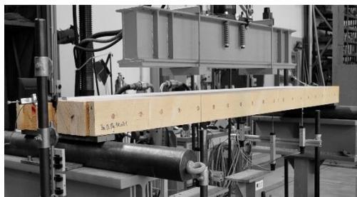
Abb. 5 – Biegeversuche an Brettstapel-Wandelement [TU Dresden].
