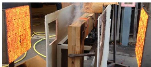
Abb. 13 - An AF-Verbindung durchgeführter Brandversuch [U Lorraine].
