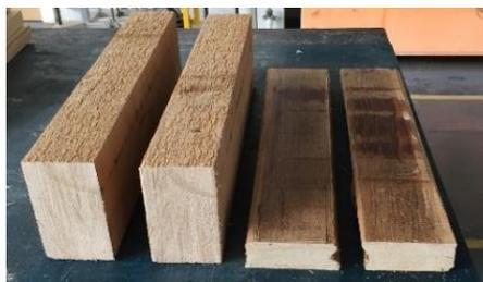
Abb. 1 – Holzprofile aus Hemlocktanne vor und nach dem Verdichten von 400 kg/m<sup>3</sup> auf 1400 kg/m<sup>3</sup> [U Liverpool].
