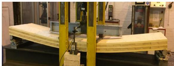
Abb. 4 – Untersuchungen an gedübelten Deckenplatten [U Liverpool].
