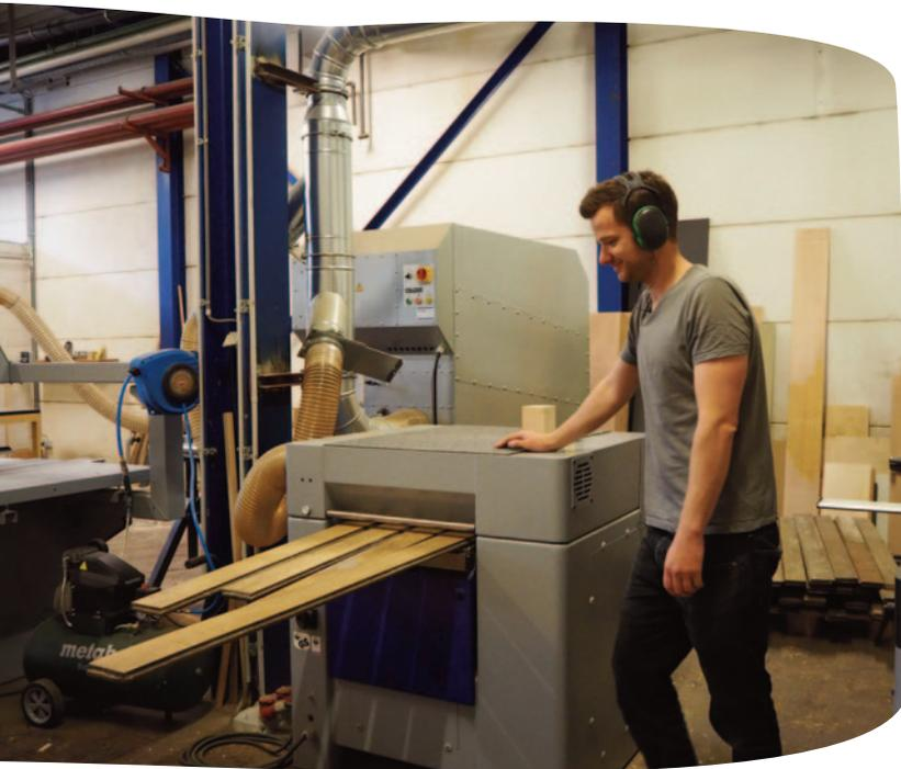
*Un bon exemple de transformation en vue du réemploi. Utiliser une défonceuse sur de vieilles planches de parquet en bois permet d'homogénéiser leur largeur et de faciliter leur réinstallation. Woodworkers est un atelier de Bruxelles spécialisé dans le mobilier (<https://www.woodworkers.be>).*
