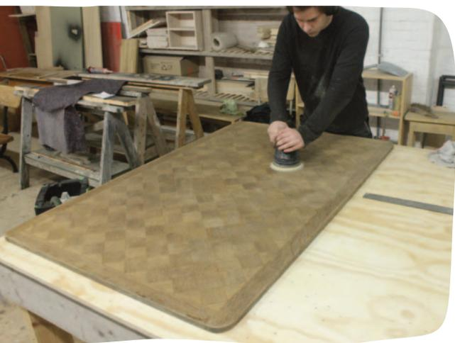
Traitement soustractif. Recup Design Workshop, ponçage d'une surface en bois
