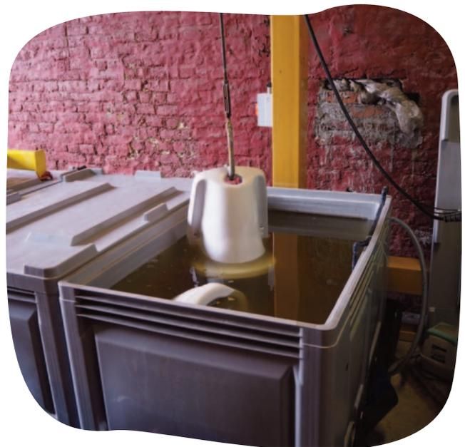
*Urinoirs trempés dans un bain d'acide pour un nettoyage en profondeur*
