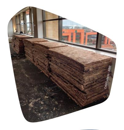
Par exemple, les dimensions de panneaux de laine minérale peuvent être mesurées directement, sur site ou hors site. D'autres performances telles que la masse volumique, l'équerrage, ou encore la planéité peuvent être mesurées de la même manière, l'évaluation de ces performances ne nécessitant qu'un matériel limité.
