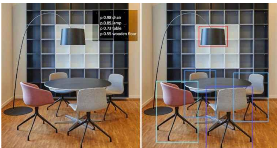
Links: Herkende objecten op foto. Rechts: Herkenning van objectaantal en -positie (bron originele foto: ATBO).
