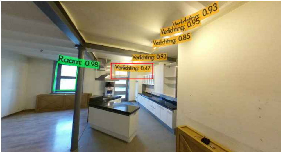
Foto van een open keuken met daarin herkenningen van verlichting en ramen. Een rood kader geeft een klein raam aan dat foutief is herkend als verlichting
