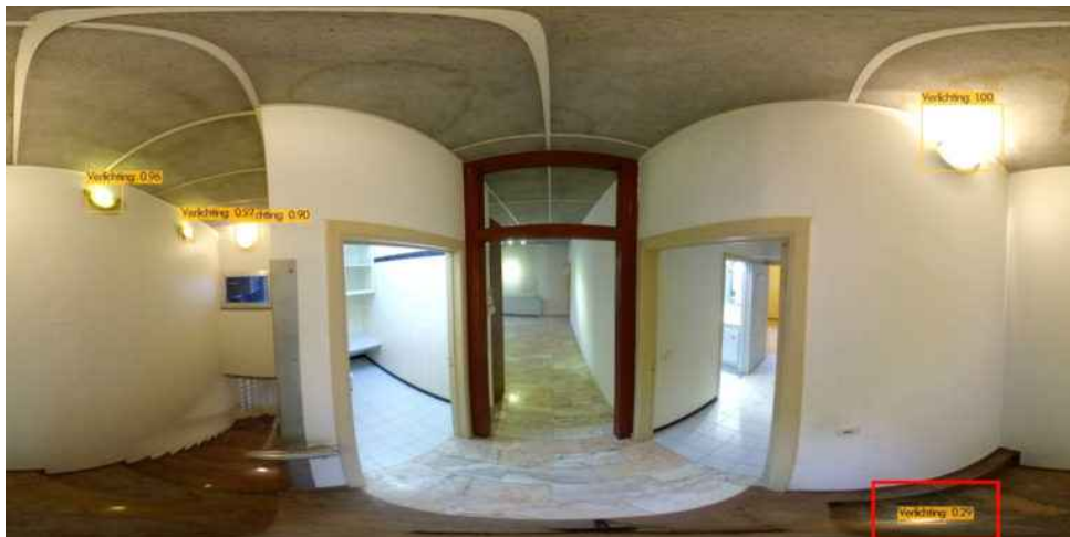
Herkenningen van verlichting. Het rode kader rechtsonder markeert een plek op de vloer die vanwege de weerschijn is aangezien voor verlichting
