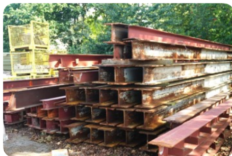
Opslag van stalen hergebruikliggers, met roestwerende beschermingslaag (rood) en zonder beschermingslaag (witte verf) © Gebruikte bouwmaterialen Weert
