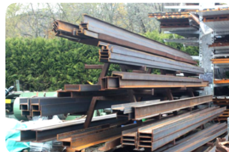
Opslag van liggers volgens profiel en formaat © Opalis (Sarl Perrin)
