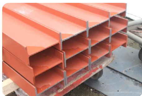
Gezaagde liggers © Opalis (Wolter Bouwmaterialen)
