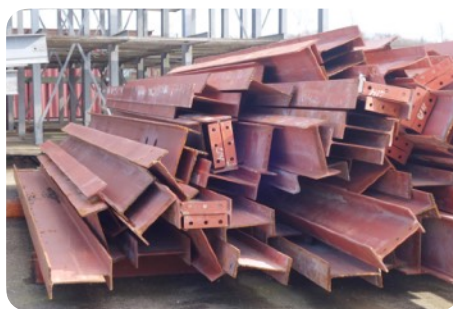
Gerecupereerde IPE-liggers, met roestwerende behandeling © Opalis (Omgekeerd Bouwen)
