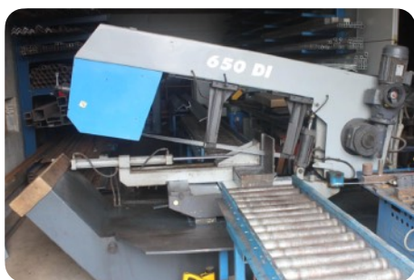
Installatie voor het zagen van liggers © Opalis (Wolter Bouwmaterialen)
