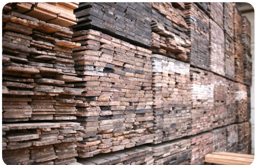
Lames de plancher en bois massif récupérées
