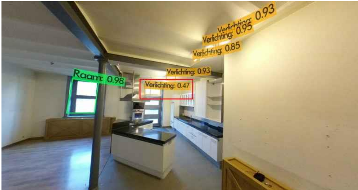
Photo d'une cuisine ouverte avec reconnaissance des lumières et des fenêtres. Un cadre rouge indique une petite fenêtre qui a été reconnue à tort comme un éclairage.
