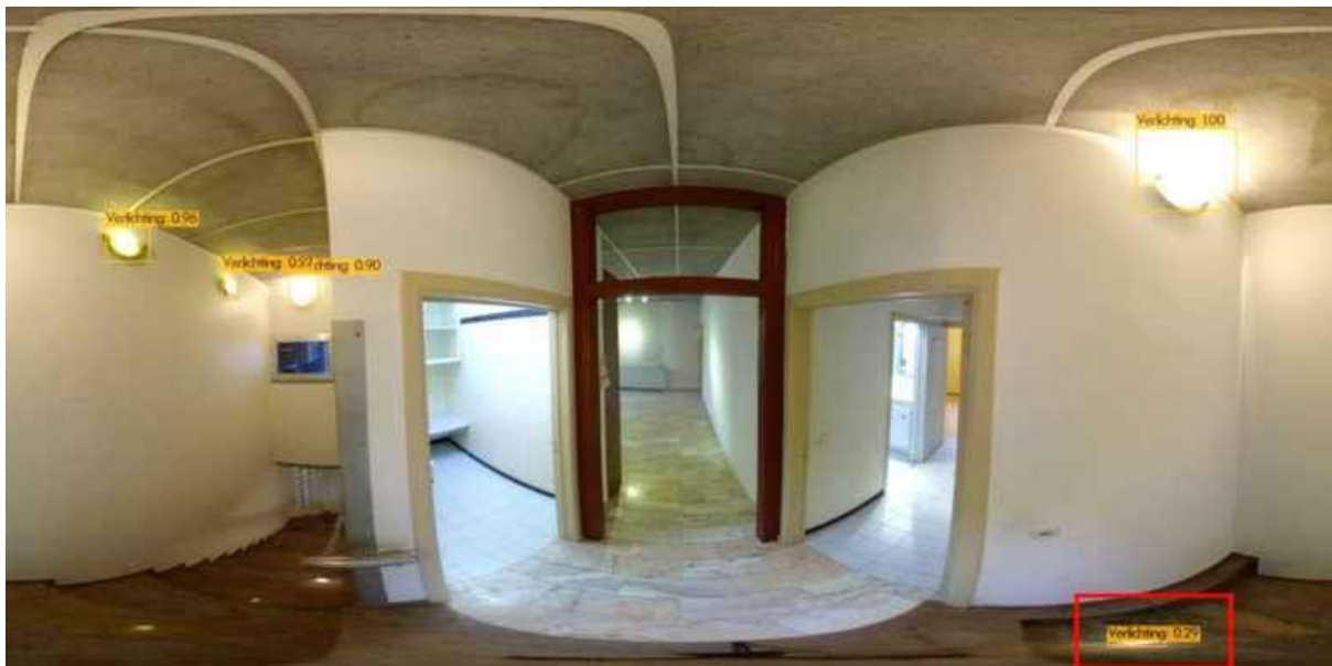
Reconnaissance de l'éclairage. Le cadre rouge dans le coin inférieur droit marque un endroit du sol que l'on pensait éclairé en raison de sa réflexion.
