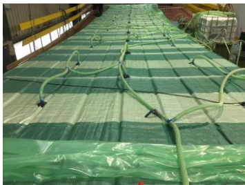
桥面是作为一个完整的元素使用真空灌注工艺制造的。
