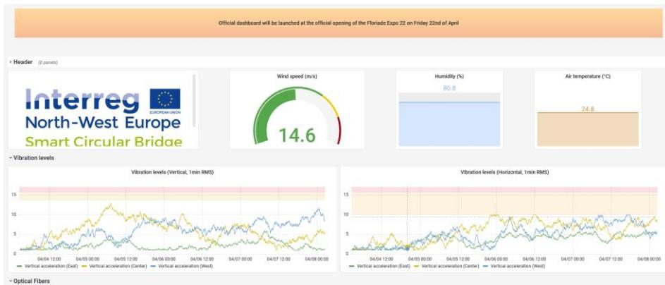
Dataene fra sensorerne kan ses på et instrumentbræt på et offentligt websted. ([dashboard.smartcircularbridge.eu/](http://dashboard.smartcircularbridge.eu/))
