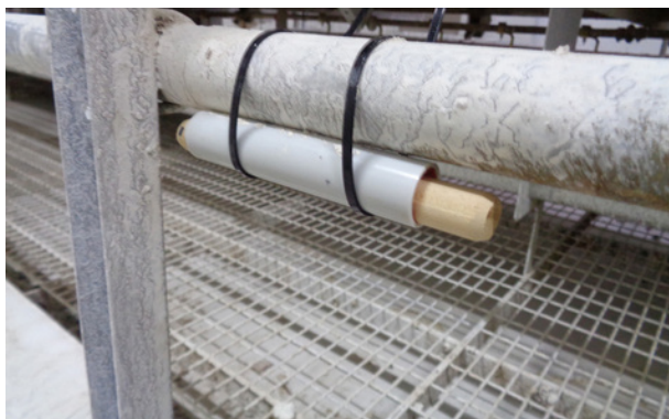
Figur 2: Stabfallen unter einer Stange befestigt
