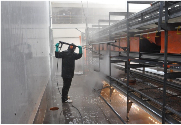
Figur 5: Nassreinigung des Volierenhaltungssystems
