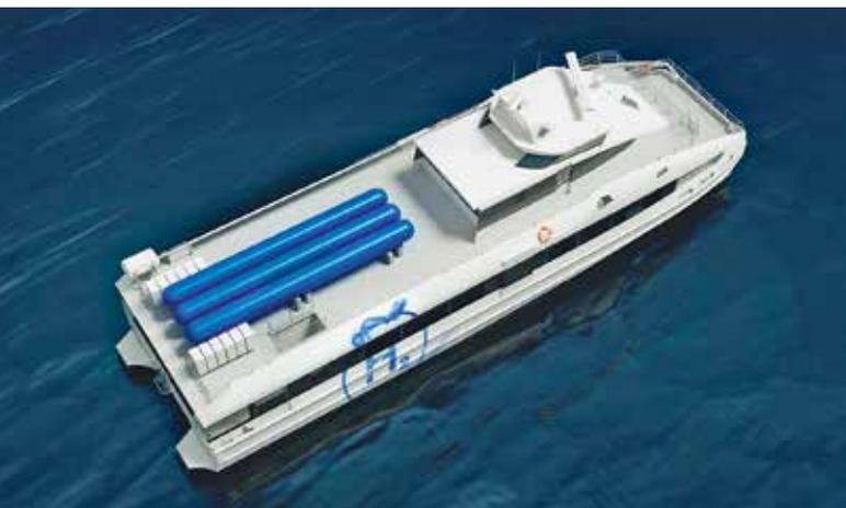
Abb. 2: H<sub>2</sub>-Technik an Bord der Fähre [Quellen: Broedrene Aa]
