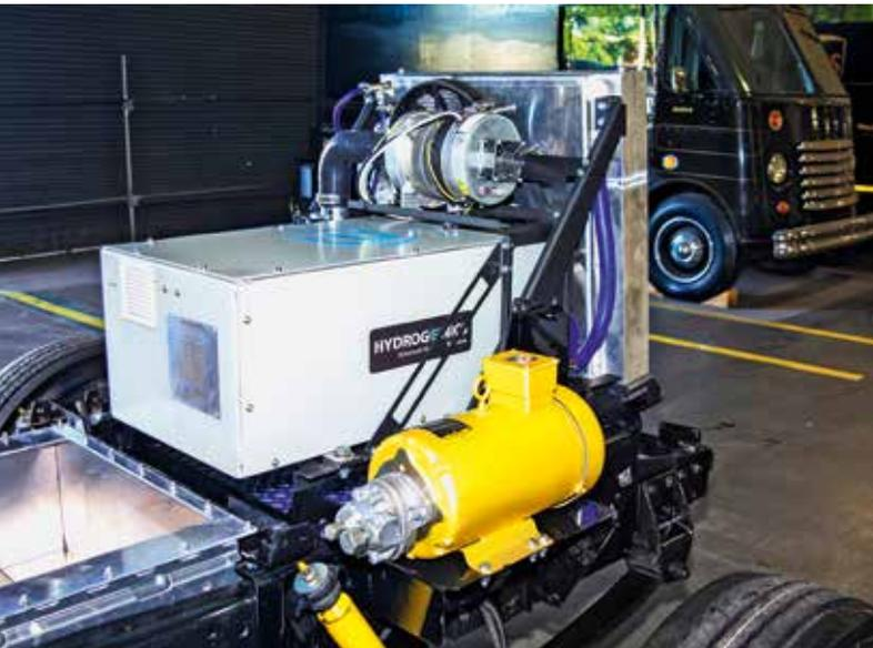
Abb. 2: BZ-System auf der UPS-Lieferwagenplattform [Quelle: UPS]
