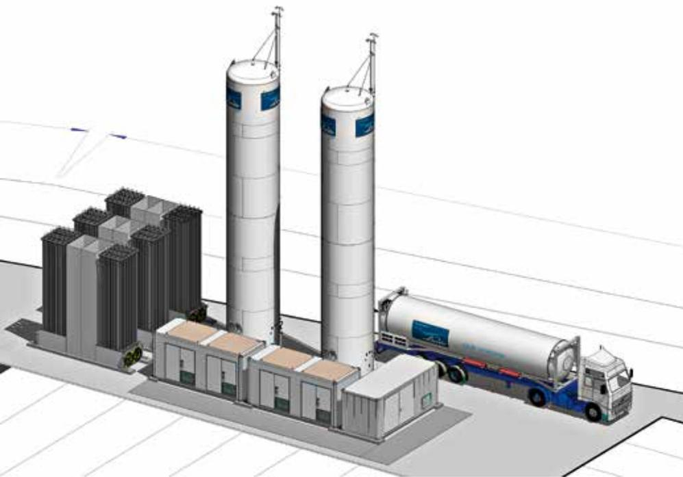
Abb. 2: H<sub>2</sub>-Station mit Anlieferung von Flüssigwasserstoff, täglicher Durchsatz 2,25 t H<sub>2</sub> pro Tag [Quelle: Linde, [1]]
