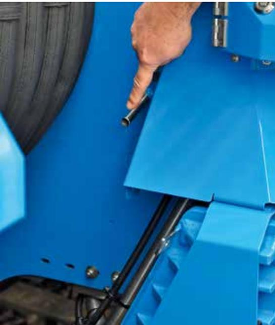
Abb. 2: Auspuff – ein dünnes Edelstahlröhrchen anstelle einer breiten dreckigen Abgasöffnung
