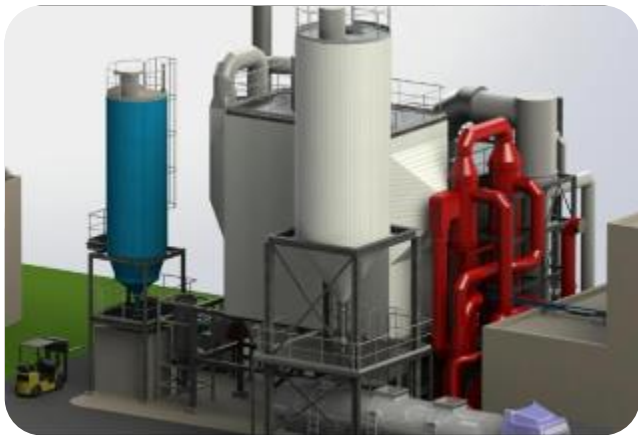
Récupérateur des boues de STEP
